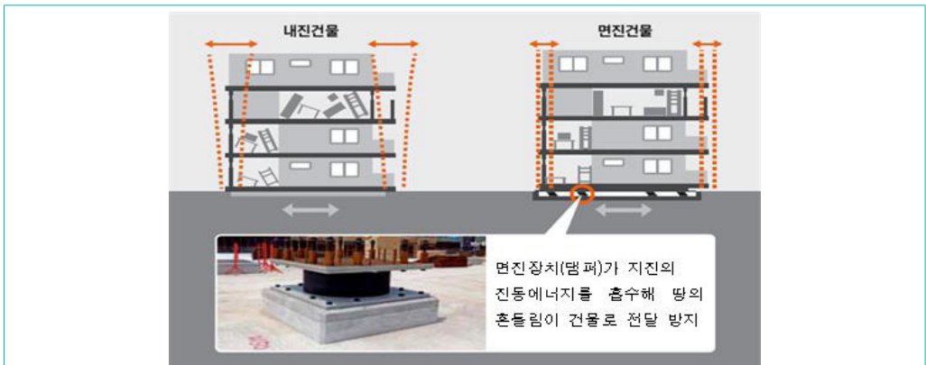
기초에 램퍼 설치
